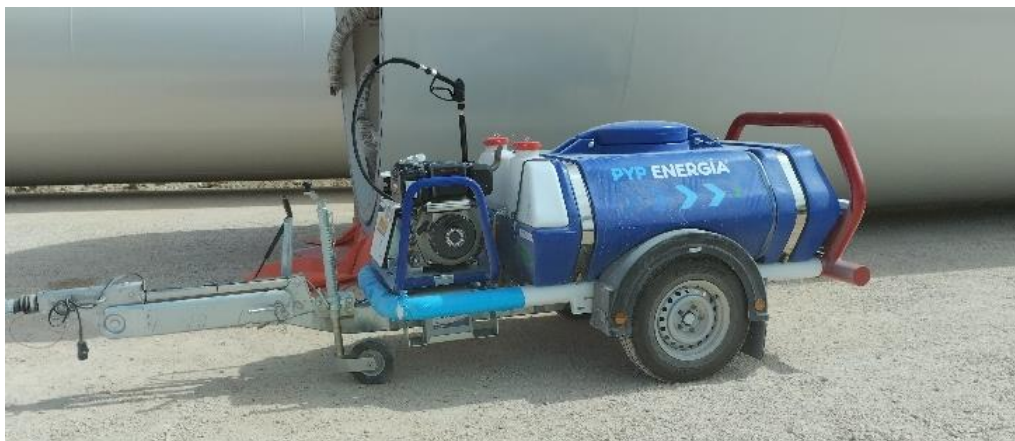
Kärcher de 500 l ubicada en la plataforma del ACS 04, y operativa para sofocar posibles conatos de incendio.
