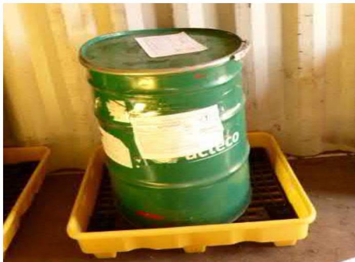
Imágenes 29, 30, 31 y 32: Exterior del contenedor destinado para el almacenamiento temporal de los depósitos de residuos peligrosos convenientemente identificado (fotografías superiores). Depósitos homologados e identificados conforme a la normativa vigente para el almacenamiento de residuos peligrosos (fotografías inferiores).
