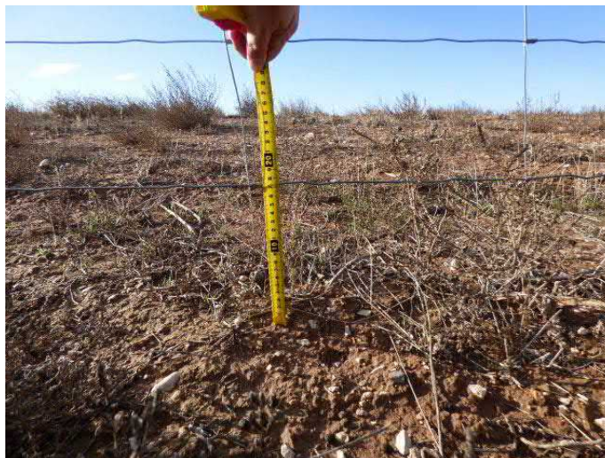
Imagen 5: Espacio libre de 15 cm entre el suelo y la valla.
