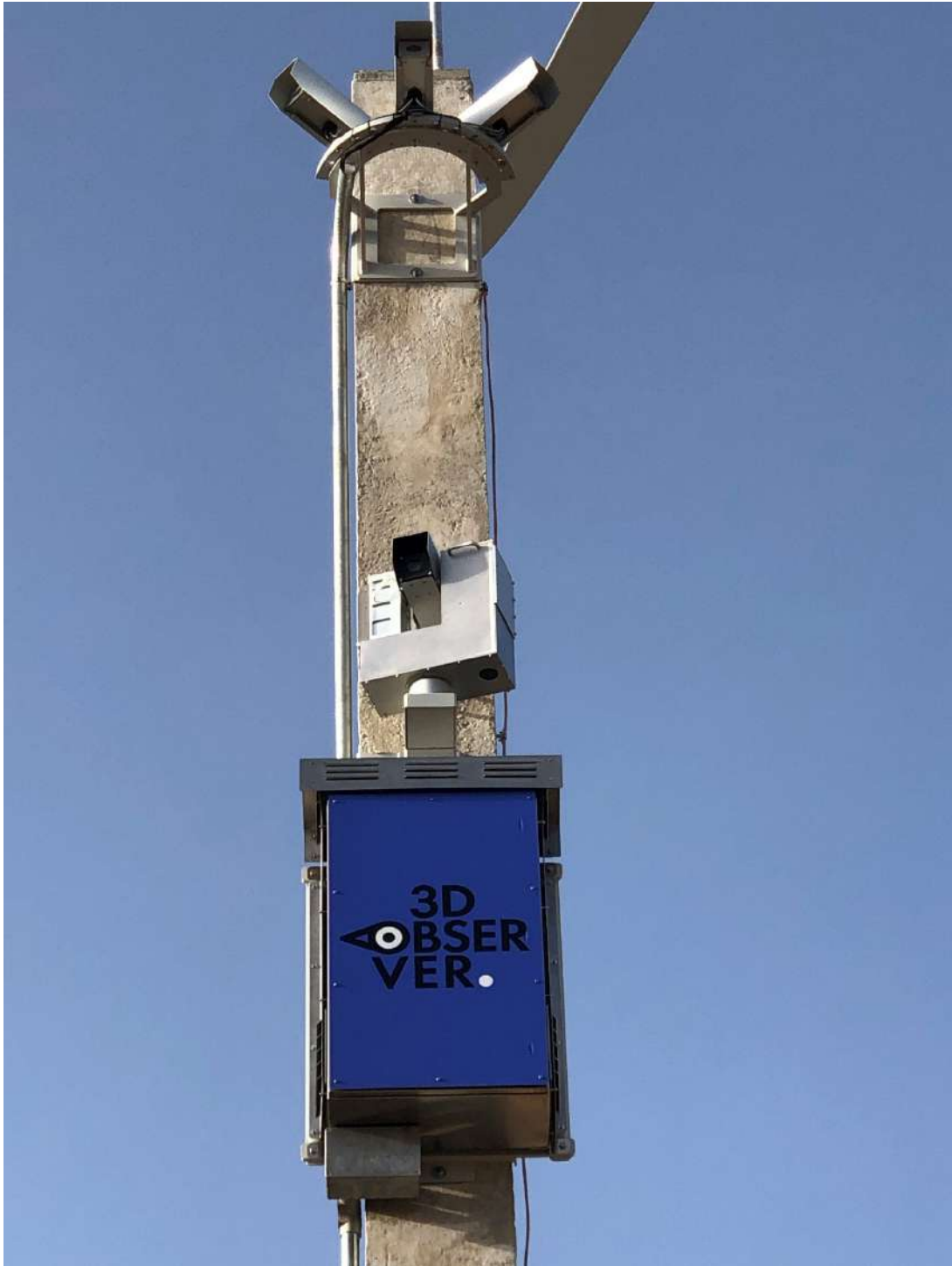
Imagen 9. Vista del 3dobsever con sistema PAN TIL para la identificación de especies.
