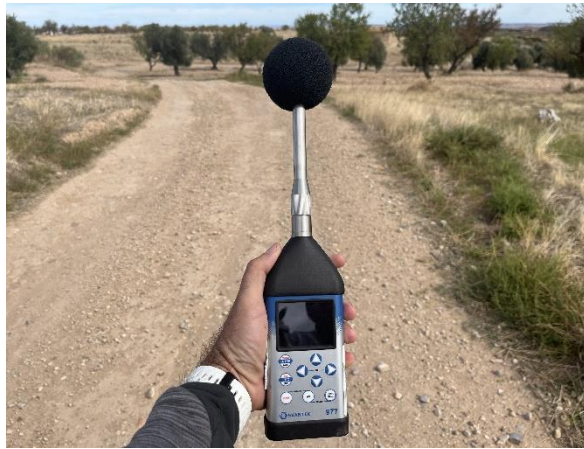
Figura 18: Sonómetro integrador modelo clase 1 SVAN 977 utilizado para la evaluación de los niveles de presión sonora en el parque eólico.
