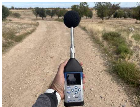
Figura 16: Sonómetro integrador modelo clase 1 SVAN 977 utilizado para la evaluación de los niveles de presión sonora en el parque eólico.
