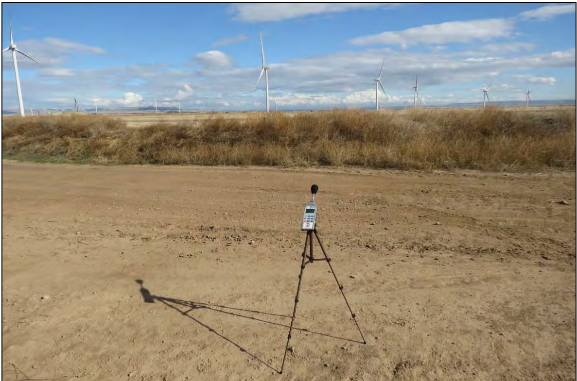
Imagen 51. Sonómetro y mediciones en PE La Nava. Fuente propia.
