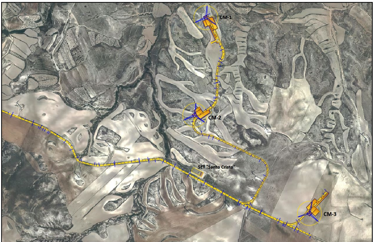
Figura 1: Parque eólico "Campo de Magallón" sobre la ortofoto georreferenciada. En azul se marca el vuelo de palas y en amarillo viales y plataformas.
