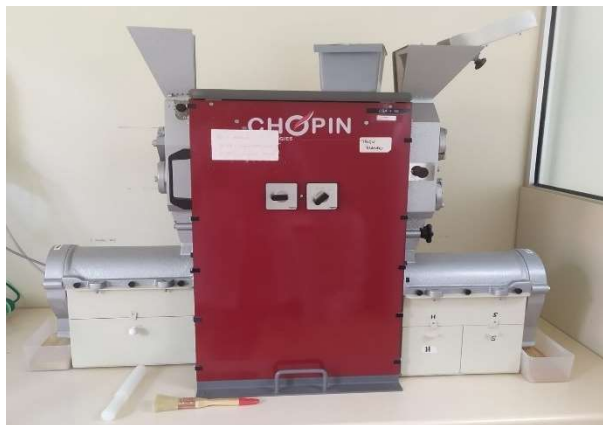
Foto 3. Molino experimental Chopin CD1
