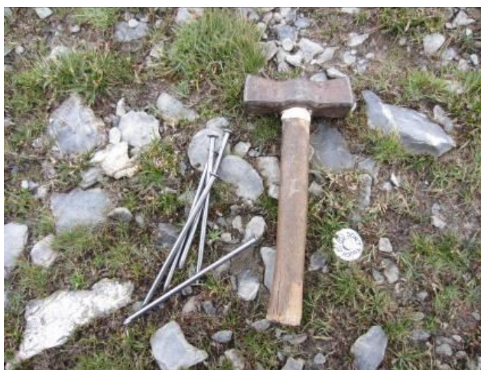
Fotografía 1.6. Sustitución piquetas con bridas de color por puntas de metal con arandelas
