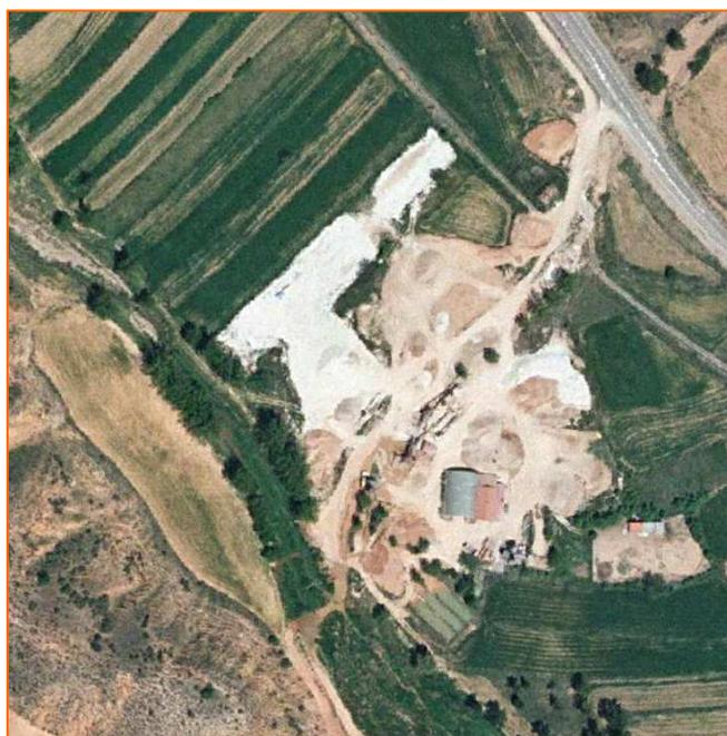
Extracción de gravas y transformación. Afecciones al DPH. Inundabilidad. Se deberían aplicar medidas correctoras y distanciar las acumulaciones y obras del cauce.
