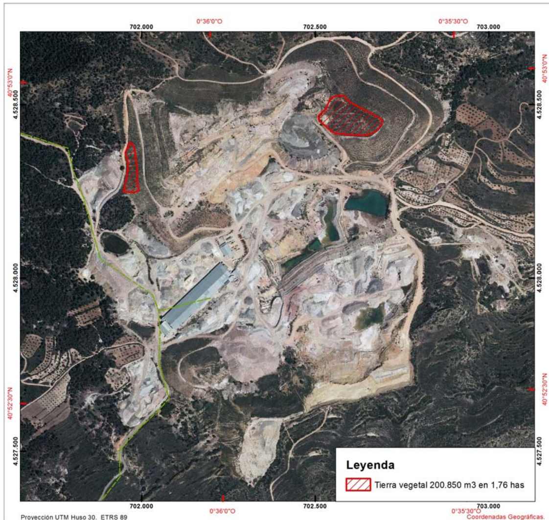
Detalle del movimiento de tierras para la revegetación
