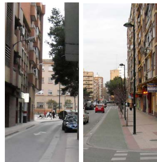
La iluminación es distinta según tramos: farola en los tramos de aceras anchas, mural en los estrechamientos.
