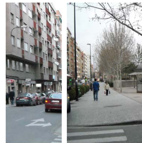
Iluminación mural unilateral salvo en el tramo de la plaza, que muestra báculos.
