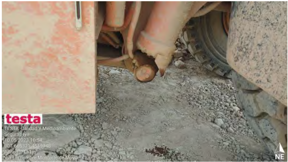
Maquinaria con derrames
